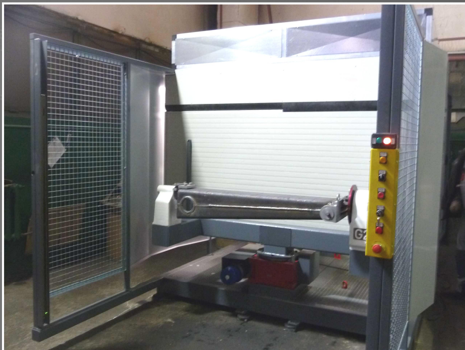
Роботизированная сварка деталей гидроманипуляторов
